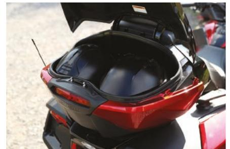
**COMPATIBLE CON LinQ** La ingeniosa integración del sistema de accesorios LinQ permite añadir y cambiar accesorios de almacenamiento de forma rápida y sencilla.
